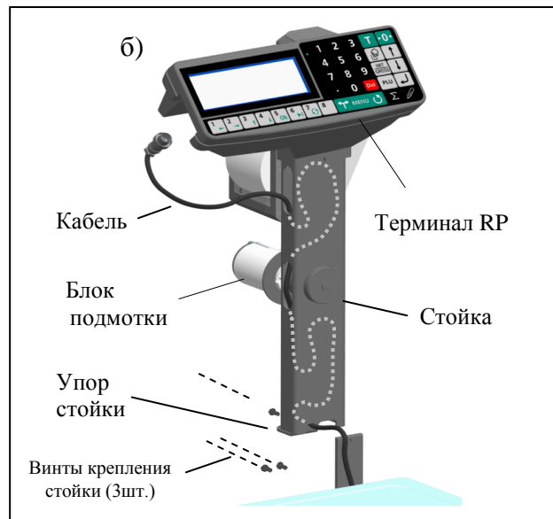
Рис. 3.3 - Сборка весов МК_RP10-1, МК_R2P10-1
