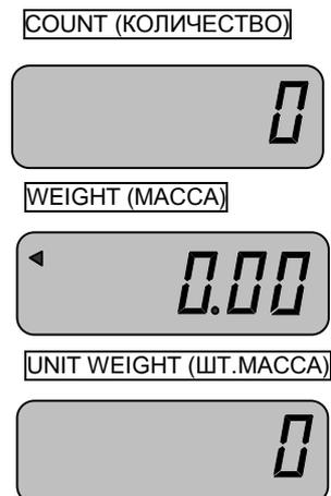
*Примечание.* За время работы с тарой возможен дрейф нулевой точки такой, что выход из режима выборки массы тары окажется заблокированным (при нажатии клавиши **TARE** на дисплее весов показания изменяться не будут и указатель «NET» останется включенным). В этом случае следует выключить питание весов и включить его вновь.
