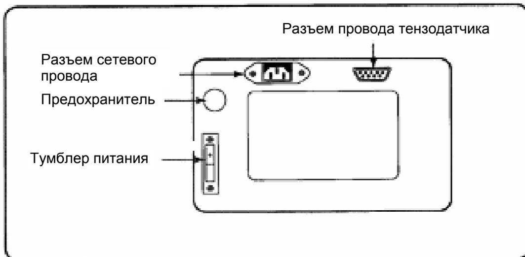
Рис. 3 Вид и назначение элементов задней стенки индикатора
